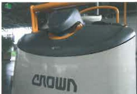
Сканер внимательно следит за тем, чтобы на пути у погрузчика не было препятствий. Он обеспечивает автоматическую остановку машины при их обнаружении.
