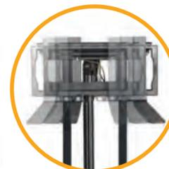
**Пятая гидравлическая функция** — опция, позволяющая контролировать навесные приспособления — например, позиционер вил с системой бокового сдвига или захваты — для выполнения требований конкретной области применения.
