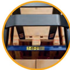
**Лазерная направляющая вил** — опция, позволяющая легко позиционировать вилы при работе на высоте для повышения точности и производительности.
