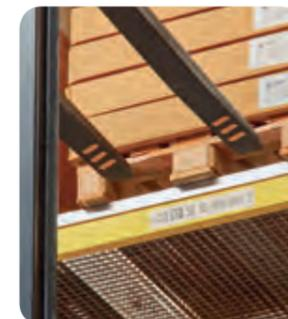
Система установки вила в горизонтальное положение — дополнительная функция ричтраков серии ESR — компенсирует отклонение мачты и каретки и автоматически выравнивает вилы относительно земли для более точного позиционирования.
