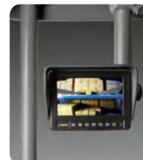
Опциональные видеокамеры на вилах или на мачте еще больше оптимизируют работу с грузами и позиционирование.
